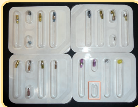
Contrôle de présence
